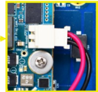
Connect the Fan to SOM Fan Header
